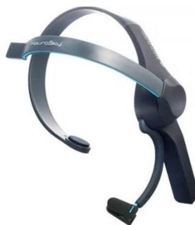
Figura 1. Dispositivo BCI (MindWave).
